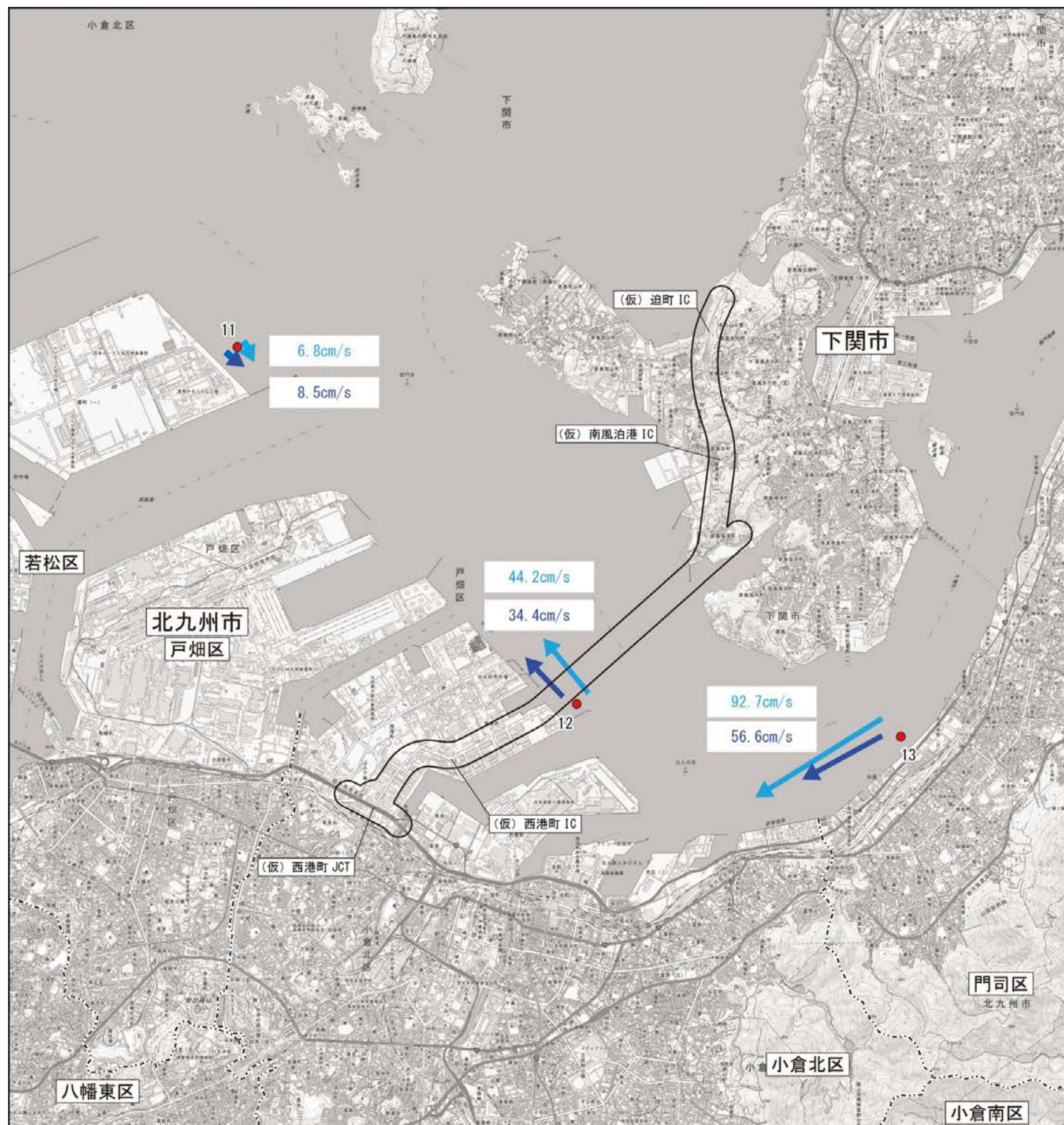
図 11.5.2-2(1) 水象の状況の調査結果(流況(流向及び流速)) (夏季: 平均大潮期 西流最強時)
