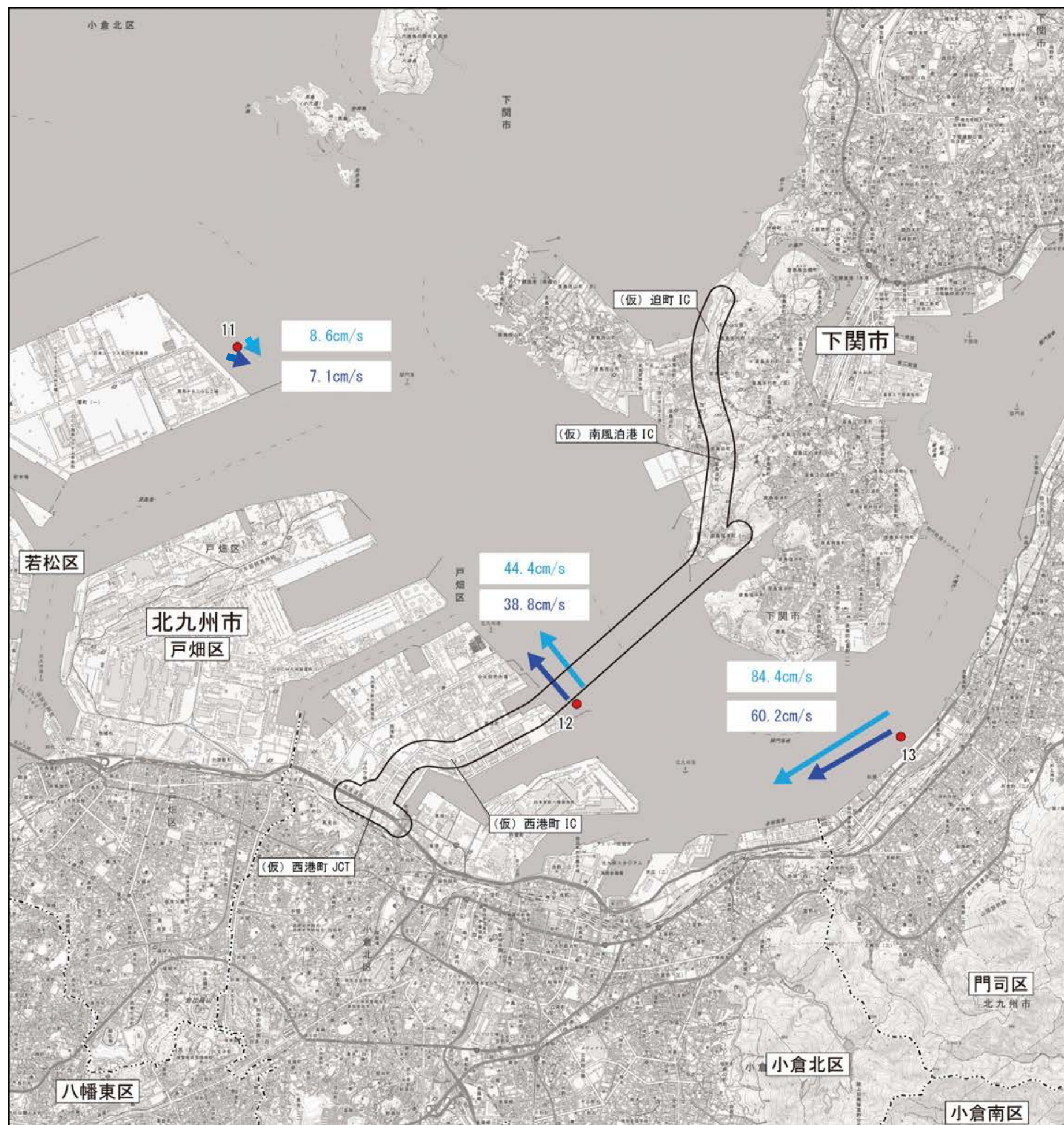
図 11.5. 2-2 (3) 水象の状況の調査結果 (流況 (流向及び流速)) (冬季: 平均大潮期 西流最強時)
