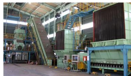
熱エネルギー代替物処理設備／汚泥処理設備／都市ゴミ焼却灰セメント原料化システム
