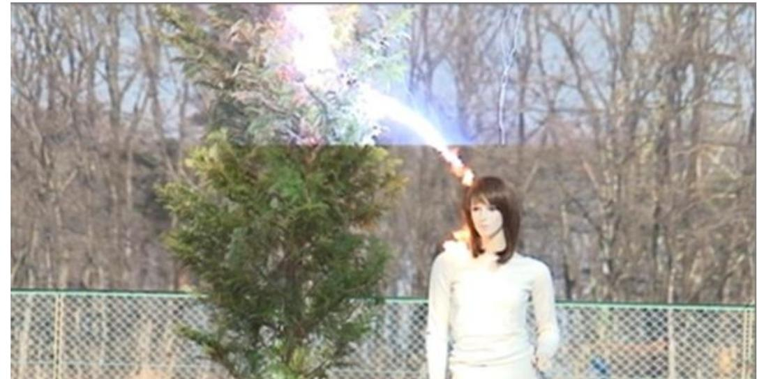
マネキンを使った側撃雷の実験(写真提供：電力中央研究所)
