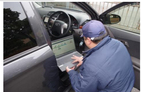
車載式故障診断装置からのデータ抽出状況
