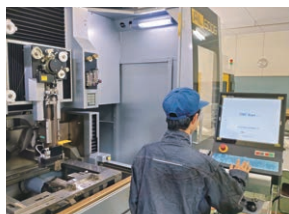
実習設備の例(ワイヤ放電加工機)
