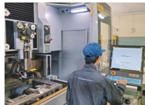
実習設備の例(ワイヤ放電加工機)
