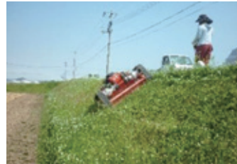
自動草刈機に対応する緩勾配法面の設置
