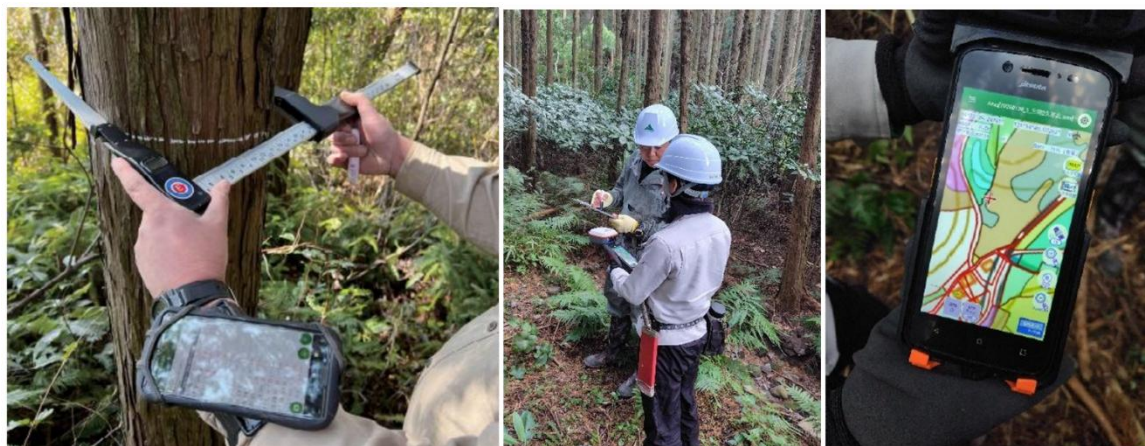
電子輪尺（左）・GNSS 受信機（右）・測量アプリの活用による資源調査の省力化
