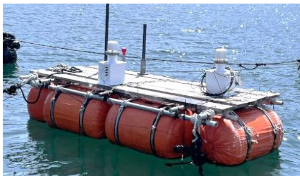
赤潮監視システムの観測筏 (下松市笠戸島)
