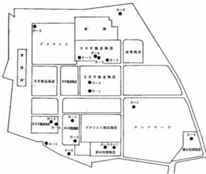
図3 製造施設周辺および工場内環境測定箇所
