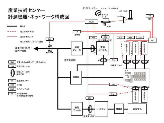
図 2-2-3 計測機器・ネットワーク構成図
