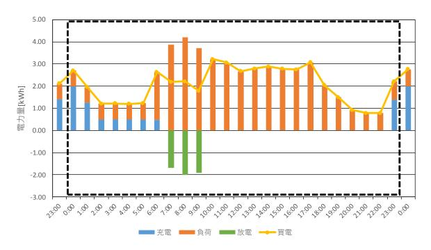
図 2-3-11 2019 年 12 月 13 日の実証試験棟の充電・負荷・放電・買電電力量の推移
