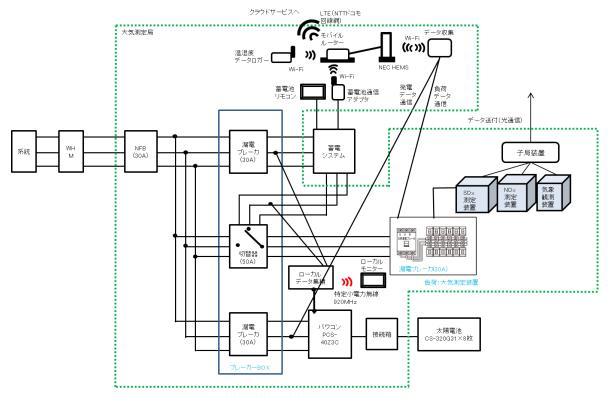
図 3-1-2 システム・測定機器・ネットワーク構成図
