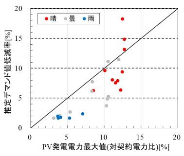
図 2-2-9 PV 発電電力最大値に対するデマンド低減率 (ケース 1)
