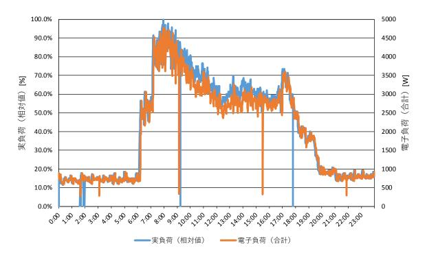
図 2-3-8 2019 年 12 月 13 日の実負荷および模擬負荷 (電子負荷)の変動 (1 分毎)
