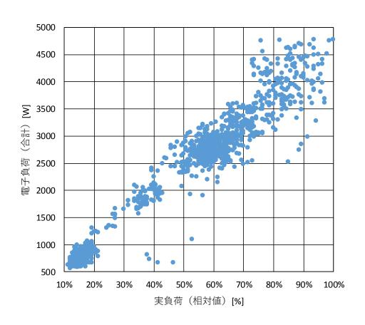
図 2-3-9 2019 年 12 月 13 日の実負荷および模擬負荷 (電子負荷合計)
