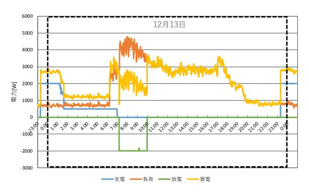
図 2-3-10 2019 年 12 月 13 日の実証試験棟の充電・負荷・放電・買電電力の推移 (1 分毎)
