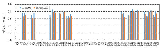
図 2-2-8 工場デマンド値(工場 DM)とデマンド低減後のデマンド値(低減後 DM) (ケース 1) デマンド値[-]は契約電力に対する比率を示す。
