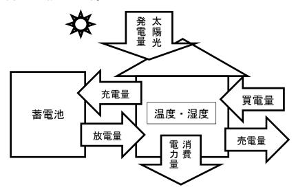
図 3-1-4 電力収支の概念図
