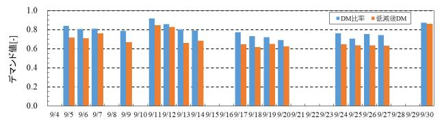
図 2-2-13 工場デマンド値(工場 DM) とデマンド低減後のデマンド値(低減後 DM) (ケース 2) デマンド値[-]は契約電力に対する比率を示す。
