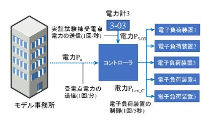
図 2-3-1 実証試験の電子負荷装置の制御の概要
