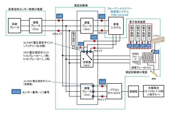
図 2-2-2 実証試験システム構成図
