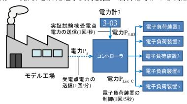
図 2-2-4 実証試験の電子負荷装置の制御の概要
