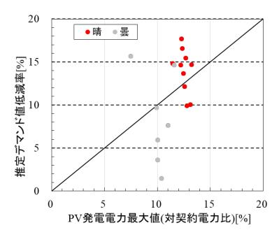
図 2-2-14 PV 発電電力最大値に対するデマンド低減率 (ケース 2)
