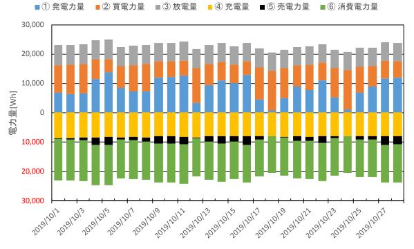
図 3-2-21 2019 年 10 月の太陽光発電量、電力消費量、売買電量、充放電量の推移
