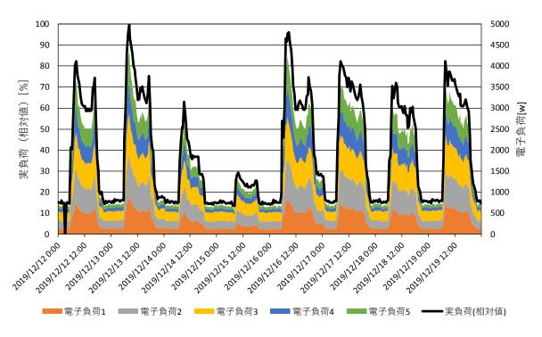
図 2-3-6 2019 年 12 月 12~19 日の実負荷および模擬負荷(電子負荷)の変動
