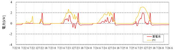
図 2-2-6 太陽光発電及び蓄電池充放電電力の 30 分平均電力 (ケース 1)
