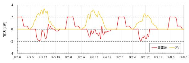
図 2-2-11 太陽光発電及び蓄電池充放電電力の 30 分平均電力 (ケース 2)
