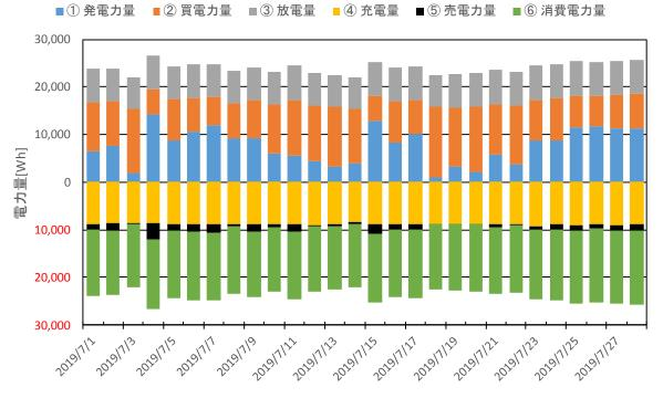
図 3-2-13 2019 年 7 月の太陽光発電量、電力消費量、売買電量、充放電量の推移
