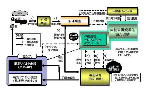
図 1-1-3 中古バッテリー回収スキーム(リユース・リビルト時)
