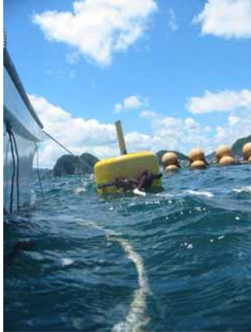
平成 18 年から通定置漁業組合の協力により水温観測ブイを設置して、水深 1m,10m,20m,30m の計 4 層の水温観測を実施しています。10 分おきに自動で観測を行っており、ブイには通信装置を取り付けているので、携帯電話のメール機能を利用して、水温情報を確認することができます。
