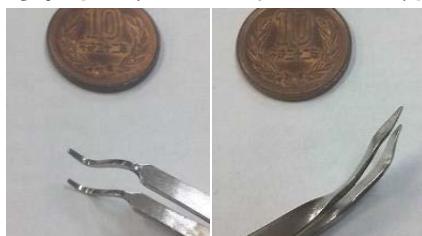
SUS316 製ピンセットの改造
