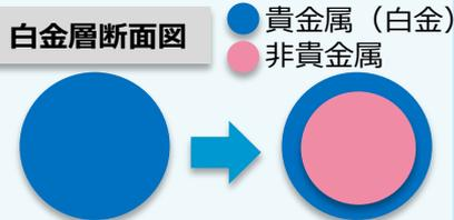
高コストな白金の使用を減らし低コスト化を図りながらも、高効率・高耐久性を両立させる電極触媒の開発
