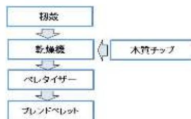
第4図 籾殻ブレンドペレット製造工程フロー
