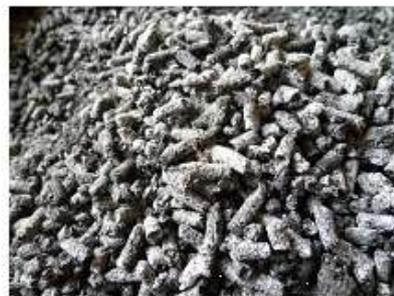
第7図 ペレットボイラー燃焼試験での籾殻ブレンドペレット4:6の灰状況
