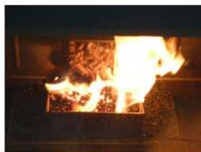
第8図 ペレットストーブでの籾殻ブレンドペレット4:6の燃焼状況
