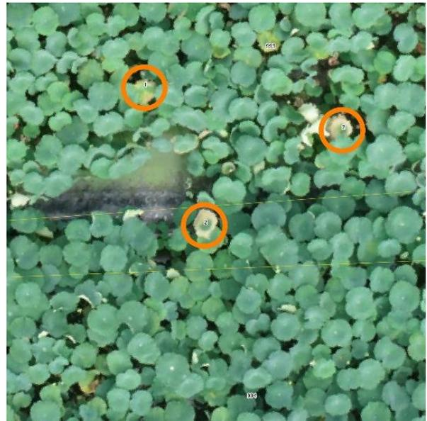
B:解像度 3cm/ピクセル (高度 112.5m)
