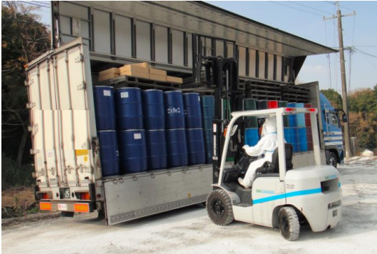
搬出用容器を運搬車両へ積み込み
