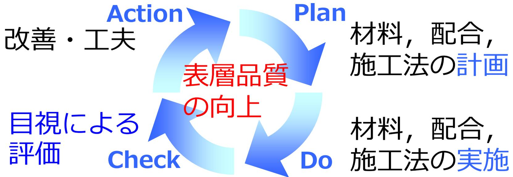
● 表面の色つや，沈みひび割れ，表面気泡，収縮ひび割れ，砂すじ・のろ漏れ，打重ね線，豆板→サンプル画像と目視に
