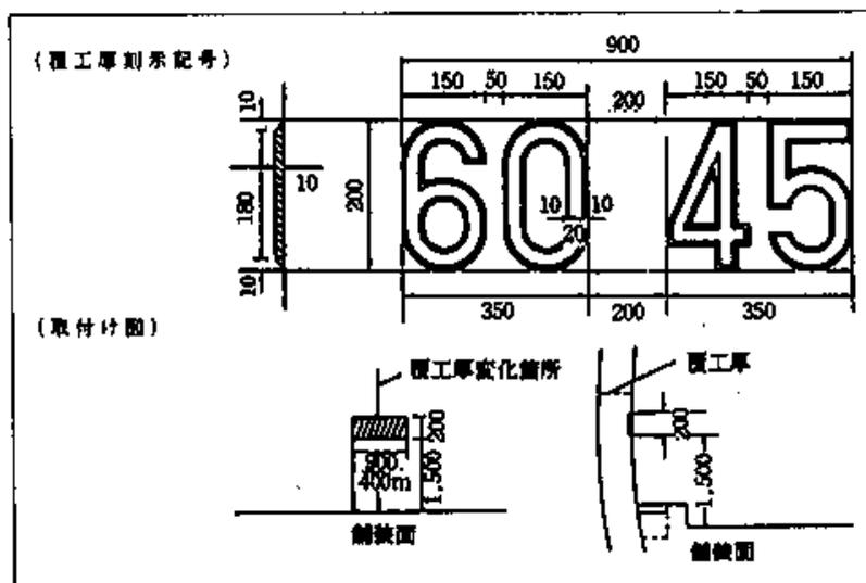
図6-1 覆工厚変化箇所の刻示標準図
