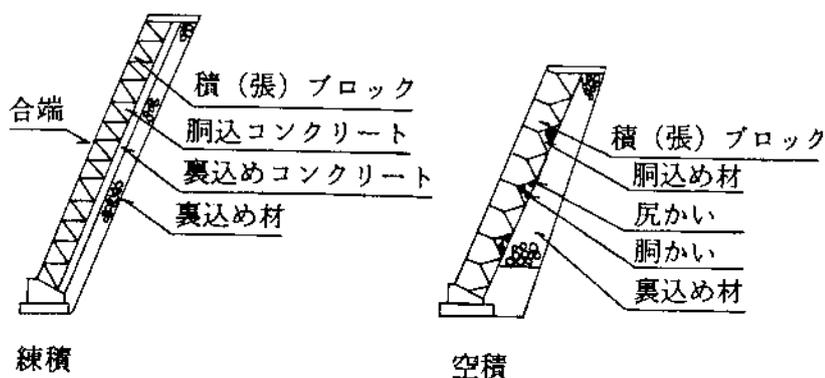
図 2-6 コンクリートブロック工
