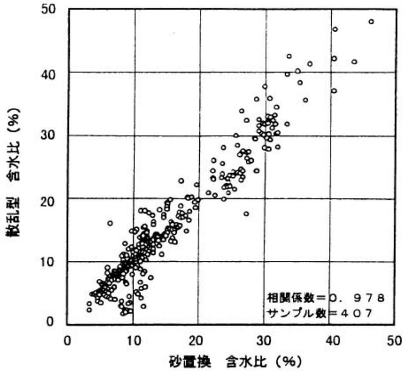
図一3 砂置換と散乱型の相関（含水比・全データ）
