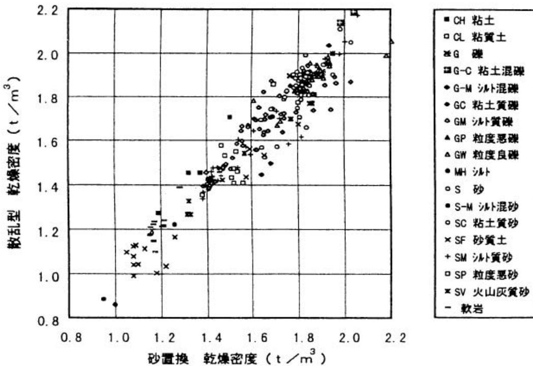
図一 2 砂置換と散乱型の相関（乾燥密度・土質別データ）
