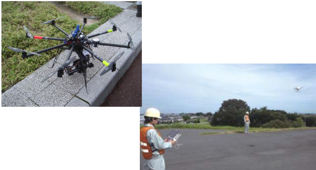
写真 6.1 ドローンを活用した施設点検
