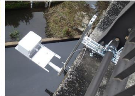
橋梁に設置するタイプ (電波や超音波で河川に触れずに計測)
