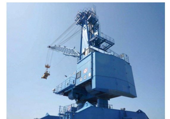
タイヤマウント式クレーン
