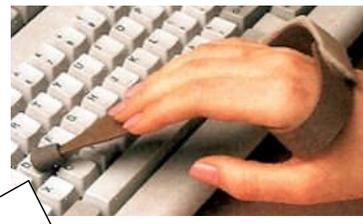
指を使ってキーボードを操作することが難しい人のために、手のひらに装着して用いる。先端のラバーチップの部分でキーボードを叩いて入力する。
