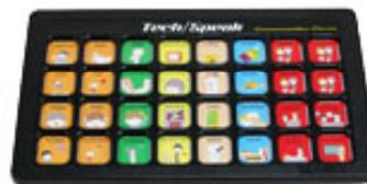
32個のボタンにそれぞれ2秒ずつの音声を録音し、再生。ダイヤルの切り替えにより、32個ずつ6場面（合計192メッセージ）の音声を録音し、再生可能。
