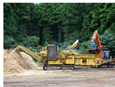
木材破砕機によるチップ製造
