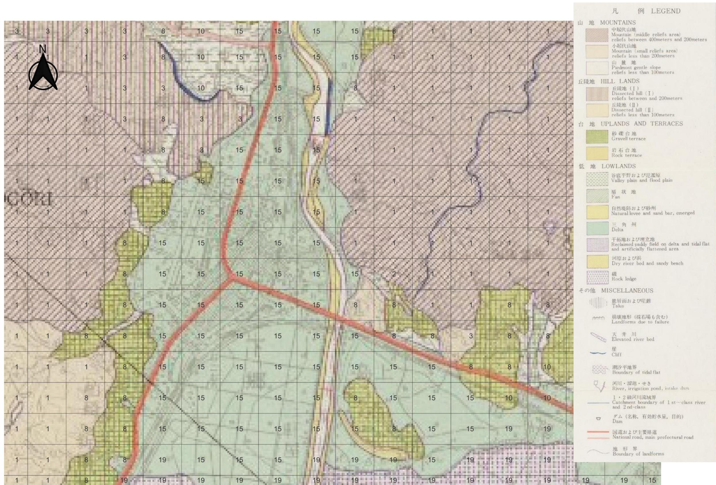
図 3 地盤モデル細分割作業内容説明図 (地形分類図 (小郡) と前回調査の 250m メッシュ・地盤モデル番号の重合せ)
