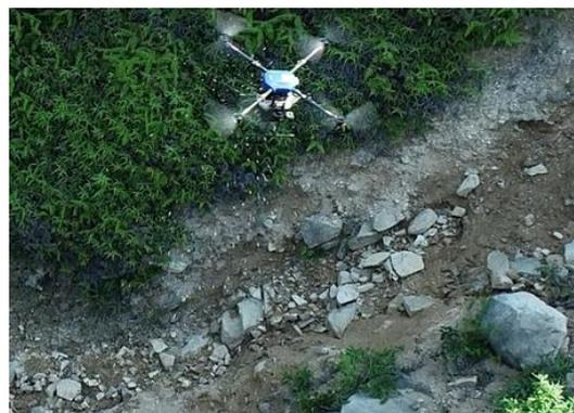
カプセルを用いた散布基材の実用性確認試験（防府市）
