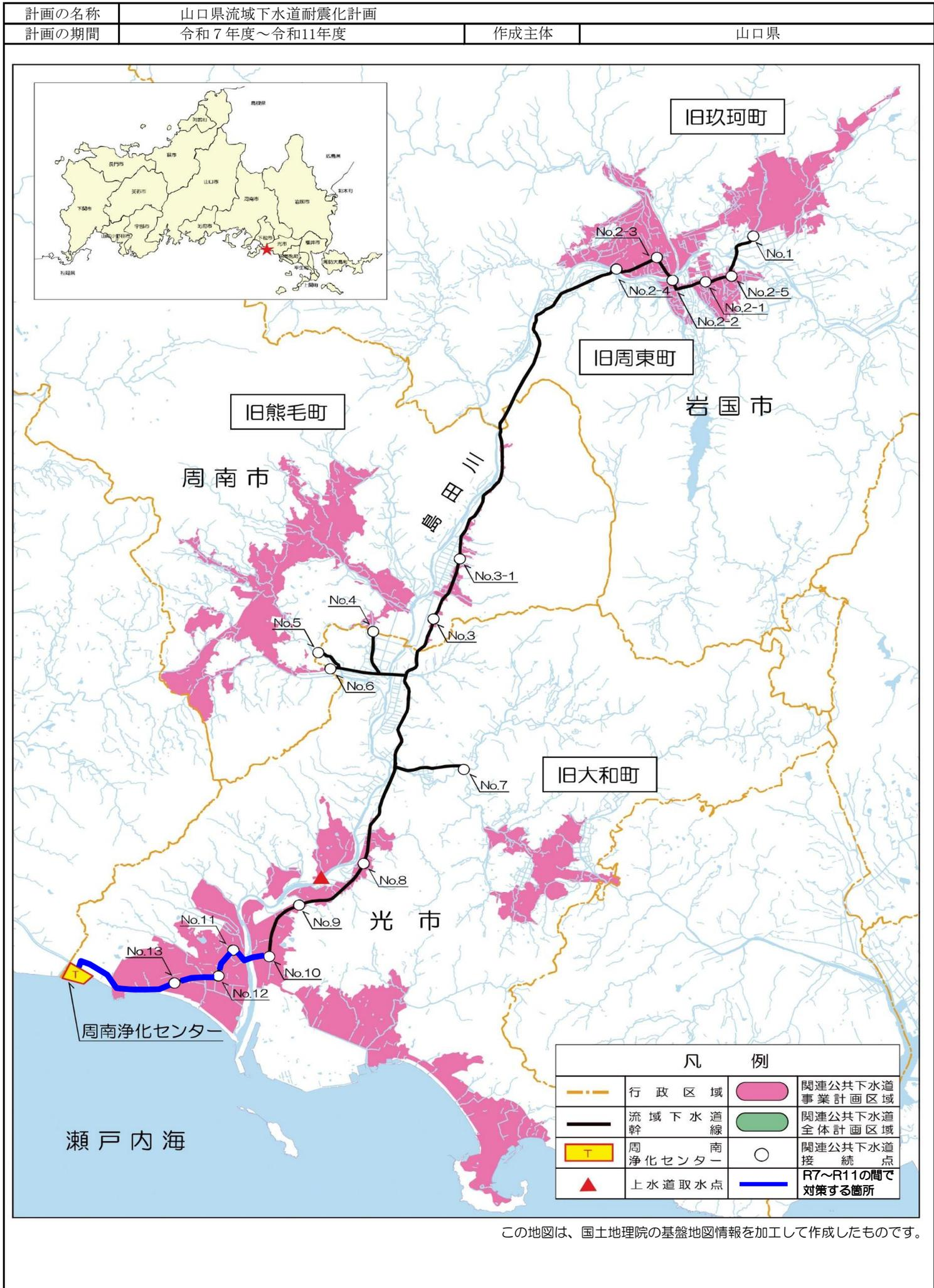
(参考図面) 下水道管路 (田布施川流域下水道)
