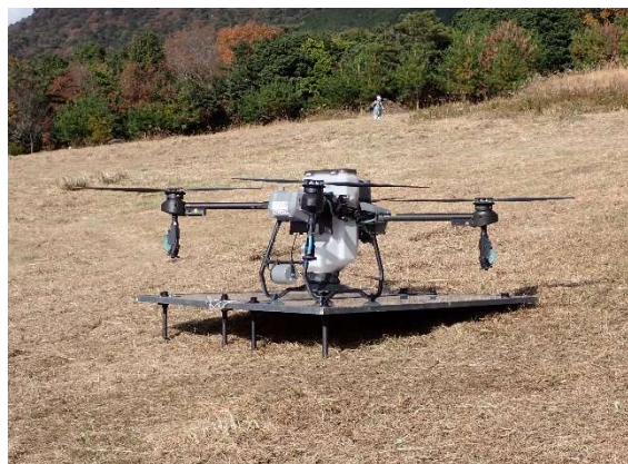
開発した傾斜地用ドローンポート (防府市)
