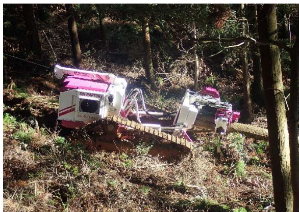
ラジコン式伐倒作業車による立木伐倒 (美祢市)
