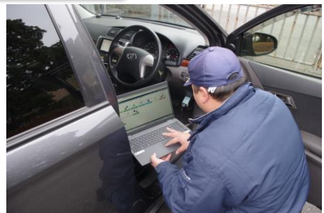
車載式故障診断装置からのデータ抽出状況
